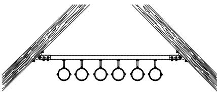
Instalación de un soporte de tuberías en superficies inclinadas
