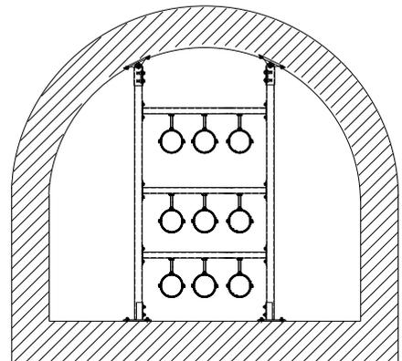
Instalación de una estructura de soporte en bóvedas o una superficie semicircular
