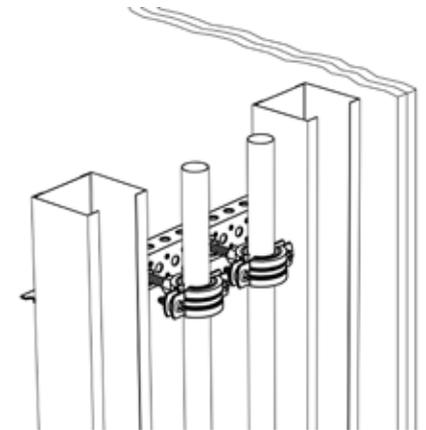
Ejemplo de montaje para guía de tubo vertical
