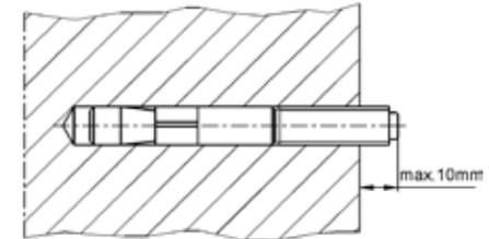
Fijación a la superficie de anclaje: La rosca del tornillo prisionero solo puede sobresalir máx. 10mm de la superficie de la pared o del techo!
